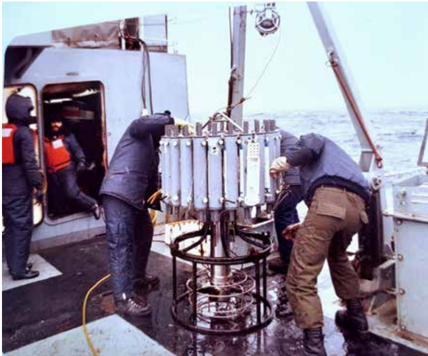
Fig 2 Roseta de 24 botellas Niskin para obtener muestras de agua de mar a diferentes profundidades, asociada a un sistema CTD (Conductivity, Temperature, Depth) que envía datos de conductividad, temperatura y profundidad a través de un cable al laboratorio de oceanografía física del B/I “Orión”.
