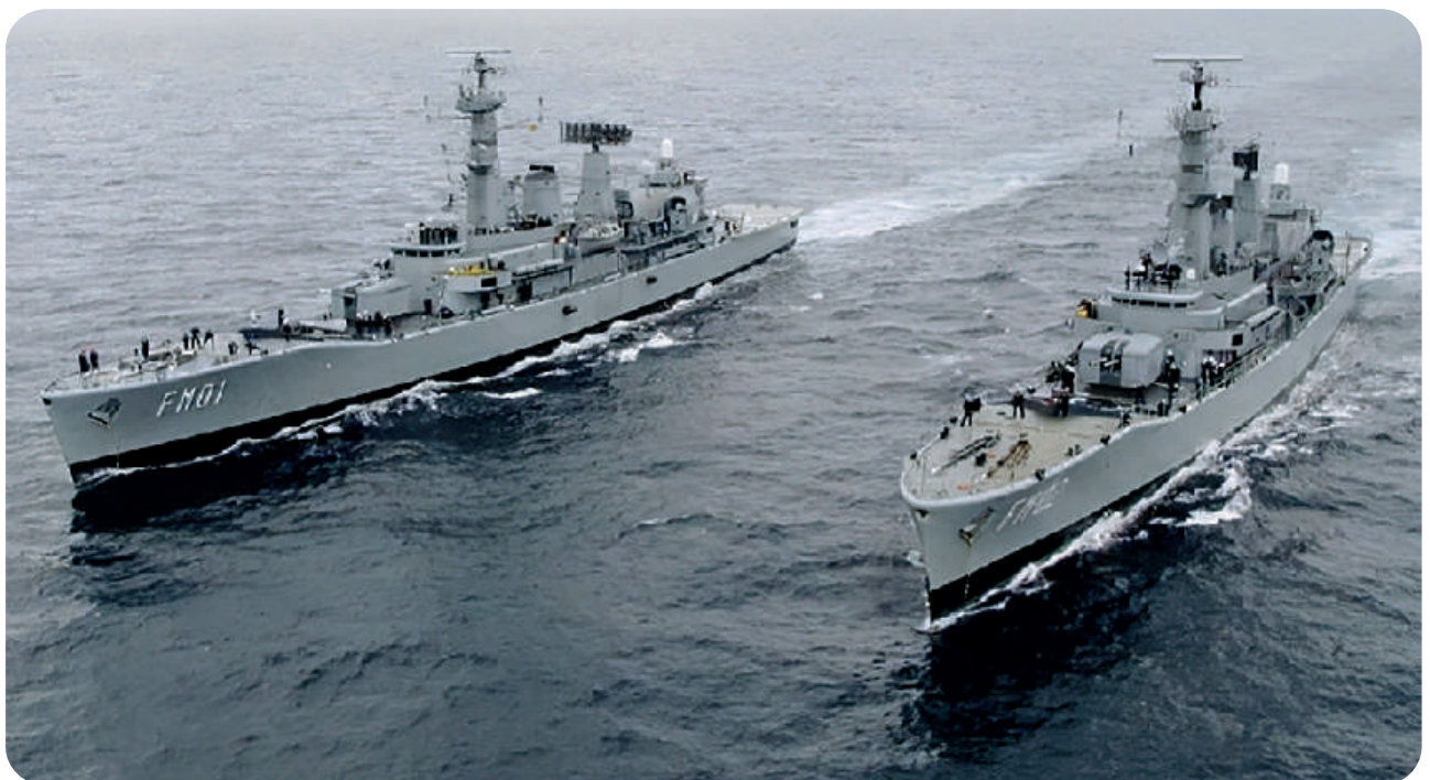
Las fragatas misileras, buques de la Armada ecuatoriana, Clase Leander con una eslora de 113mts, plataforma porta helicópteros y una dotación de 250 tripulantes representan la evolución del Poder Naval Ecuatoriano. Fuente: Archivo fotográfico Armada del Ecuador
