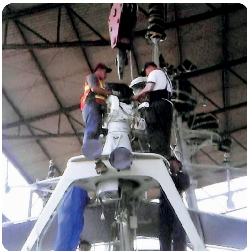
Puesta del radar de control de tiro durante el proyecto. Fuente: Revista de Marina, octubre 2011 https://biblioteca.armada.mil.ec/omeka/files/original/aaf7fbS8838c5574772febd84f8ceS88.pdf
