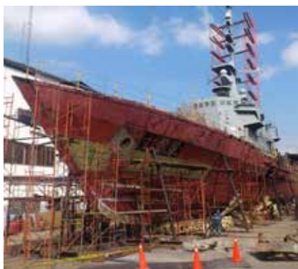
Trabajos de cambio de planchaje y estructurales en la Corbeta Misilera "Manabí" Fuente: Proyecto Corbetas – ASTINAVE EP
